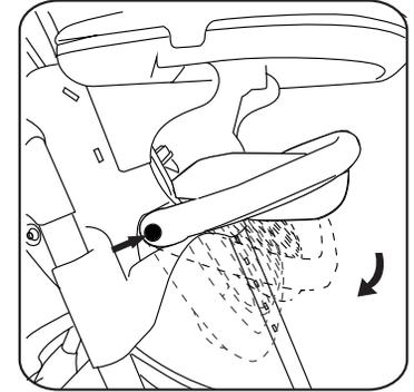
6. Ajuste del respaldo: Mantén oprimido el botón que se encuentra detrás del respaldo, y jala el respaldo que puede ajustarse hacia adelante o hacia atrás)
