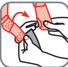
4. Coloque la correa de arnés 1 den la placa de metal como se muestra a parte cosidas en los extremos de las correas del arnés deben estar hacia el de frente de usted.
