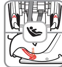
**⚠ADVERTENCIA:** No utilizar el cinturón de anclaje inferior junto con el regazo del vehículo o el cinturón de regazo / hombro. Fije los ganchos de anclaje inferiores a los archivos adjuntos de almacenamiento como se muestra en la instalación de cinturones de vehículos.
