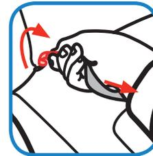
Desengancharlo del anclaje apretando la palanca de resorte en el gancho, gancho empujando de nuevo en el pliegue del asiento, y torsión. A continuación, tire de él hacia fuera del asiento del vehículo.
