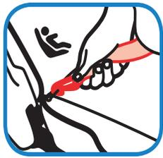
7 Fije los ganchos de anclaje inferior de anclaje inferior de vehículos
