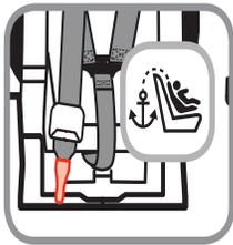
Asegure el gancho de sujeción cuando se usa mirando hacia atrás. Fije el gancho de la correa de la fijación de almacenamiento como se muestra y apriete suavemente para eliminar la holgura. Compruebe el cinturón del vehículo antes de cada uso.
