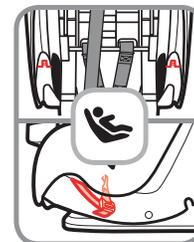
**⚠ ADVERTENCIA:** No utilizar el cinturón de anclaje inferior junto con el regazo del vehículo o el cinturón de regazo / hombro. Fije los ganchos de anclaje inferiores a los archivos adjuntos de almacenamiento como se muestra en la instalación de cinturones de vehículos.
