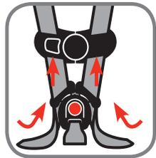
1. Introducir la hebilla y el clip para el pecho extremos correas del arnés pasan por la parte posterior de lengüetas de la hebilla ya través de la parte delantera del clip pecho para atrás como se muestra.
